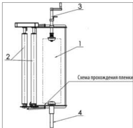
1-ролик пленки; 2-алюминевый валик; 3-винт регулировочный; 4-конус поддерживающий Рисунок 5.4 – Подаватель пленки
